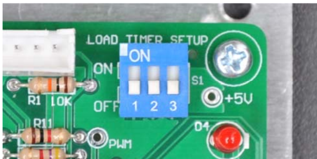
รูปที่ 4 ดิพสวิทช์สำหรับตั้งค่า DC Load ไทม์เมอร์
