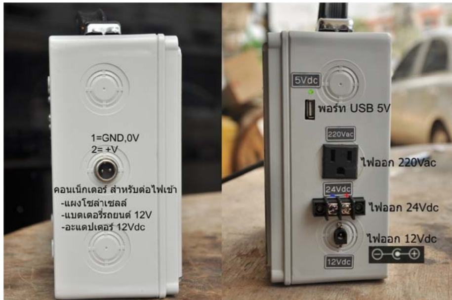
ภาพด้านข้าง คอนเน็กเตอร์สำหรับเชื่อมต่อกับอุปกรณ์ต่างๆ
